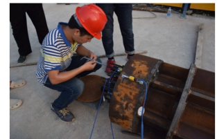
图 6 预应力试验数据采集
